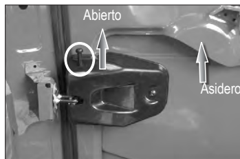
Seguro interior de las puertas
